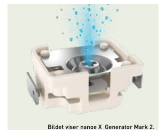
4 | Krever ikke vedlikehold og utskifting. nanoe™ X er en filterfri løsning som ikke trenger vedlikehold. Den er laget av titan og har en atomiseringselektrode som skaper kondens under genereringsprosessen.
